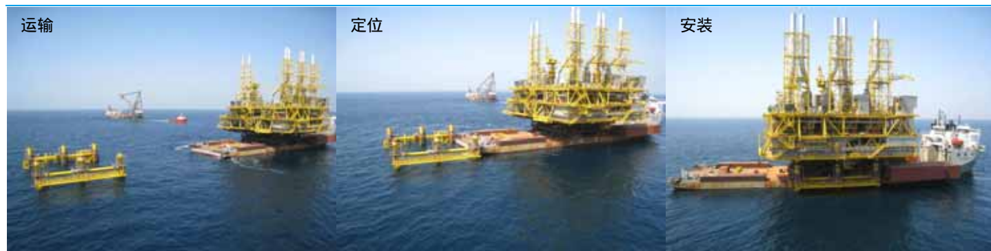
图表44：Open Stern 型的半潜船能更好的执行安装任务
