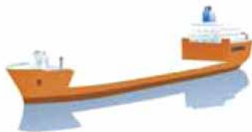
图表43：油轮改造的半潜船
