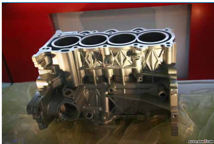
图表38：铸铁发动机中气缸套和气缸体铸造成一体
