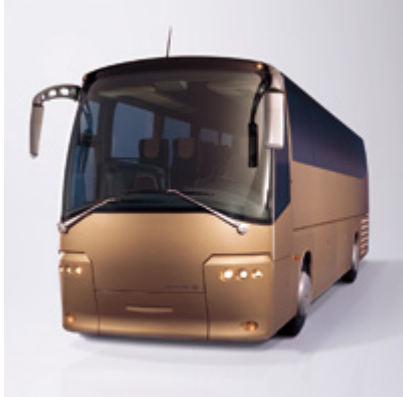
图 2: BOVA 客车的前围滴水造型
