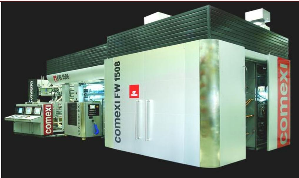
西班牙 COMEXI 八色柔板印刷机 机速:500m/min
