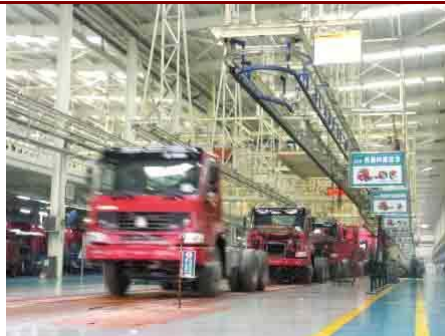
图 8: 济南卡车总装线
