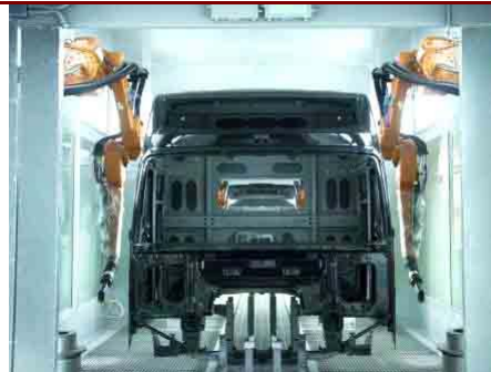
图 9: 济南卡车涂装线
