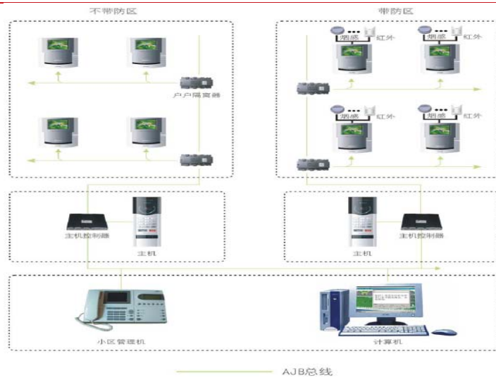
图表 12：模拟楼宇对讲系统的代表性系统方案
