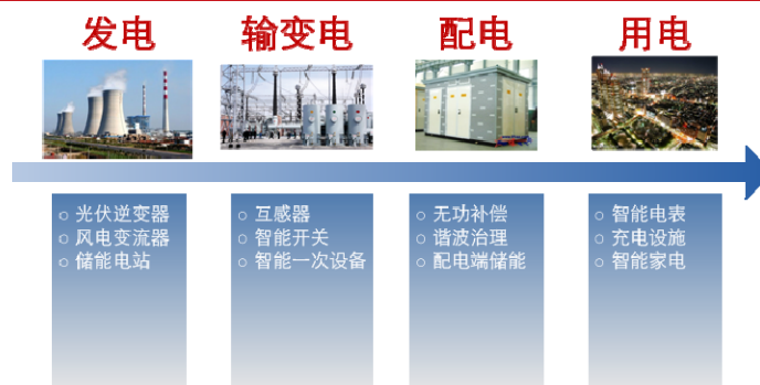
图表 15: 智能电网建设各环节涉及主要设备
