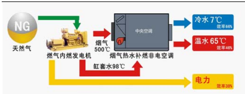
图表 3. 天然气电热冷联供
